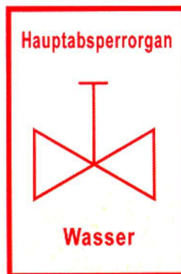
Hauptabsperrrorgan (z.B. Wasser*)
