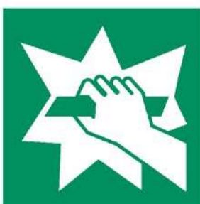
E008 Notausgangsvorrichtung, die nach Zerschlagen einer Scheibe zu erreichen ist
