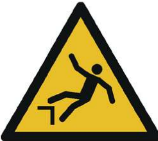
W008 Warnung vor Absturzgefahr
