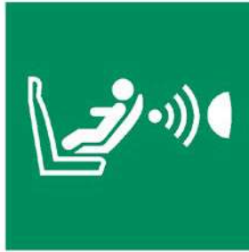
E014 Erkennungssystem für das Vorhandensein und die Ori- entierung eines Kindersitzes (en: CPOD)
