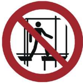
P025 Benutzen des unvollständigen Gerüsts verboten
