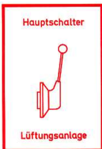
Hauptschalter für elektrische Einrichtungen (z.B. Lüftungsanlage*)
