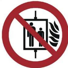
P020 Aufzug im Brandfall nicht benutzen
