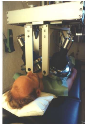
Messung im Teilkörperzähler (Lungenmessung)
