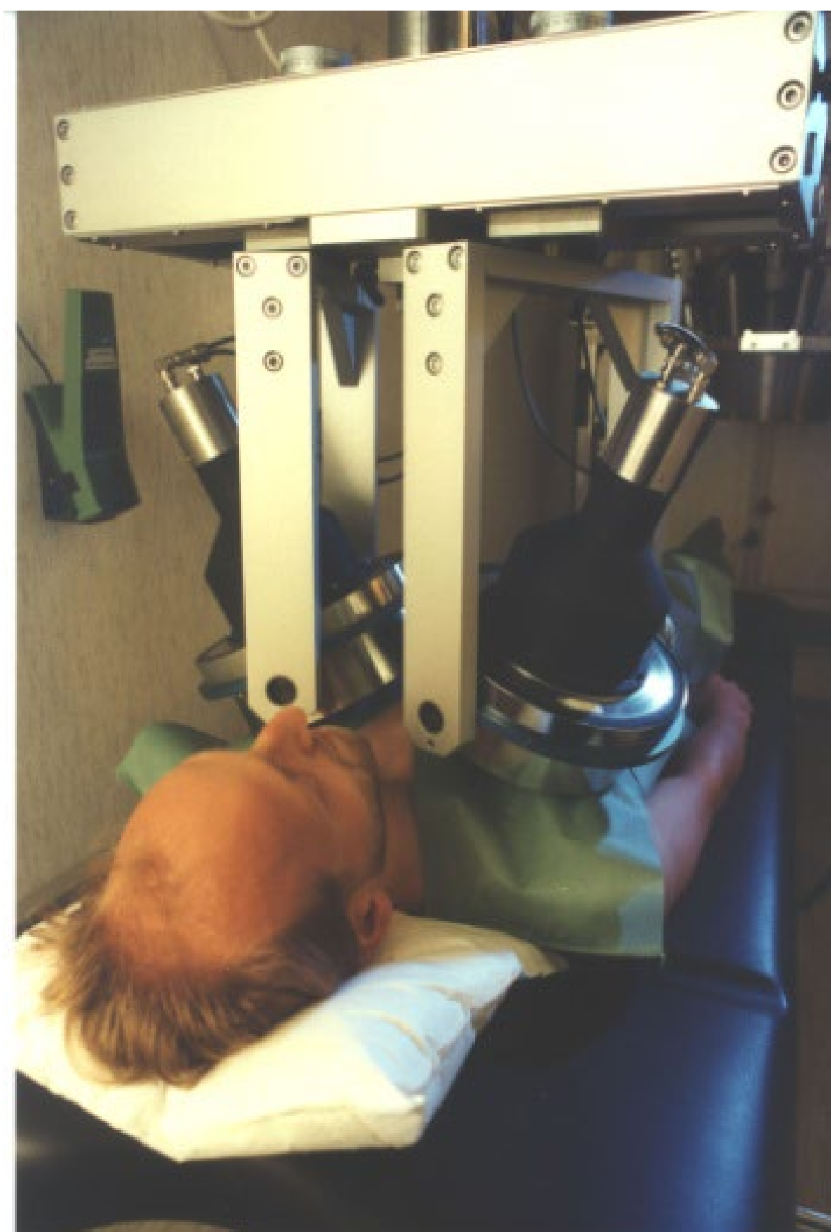
Messung im Teilkörperzähler (Lungenmessung)
